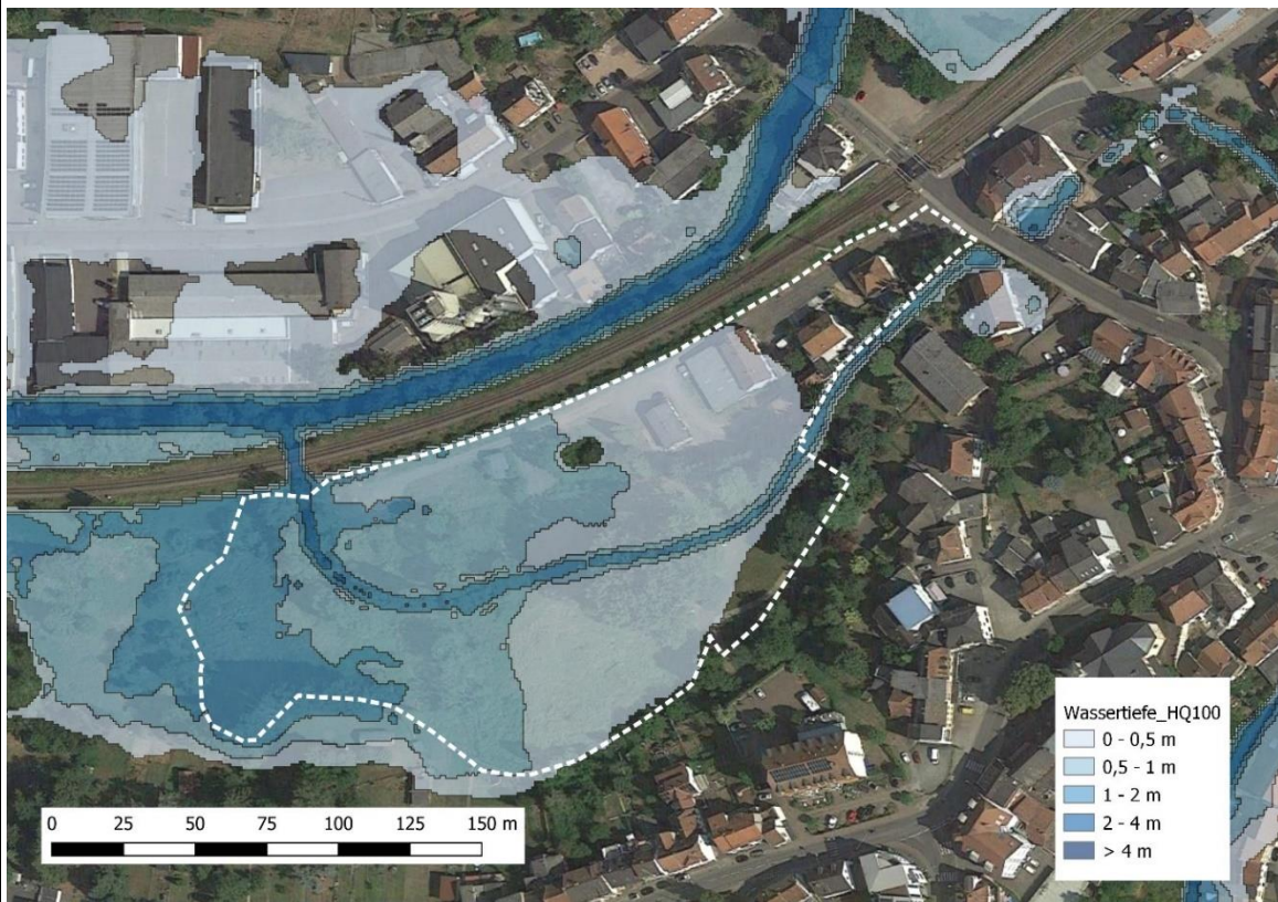
Abbildung 21: Potenzieller Standort – 5. Bereich „Fläche zwischen der Bahnlinie und dem „Wiesbach“ südwestlich der Bahnhofstraße“ – Überschwemmungsrisiko
