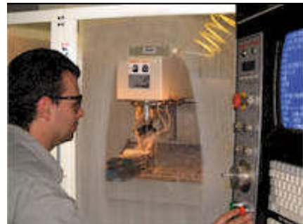
Mit einem Air Stik™ Window Blowoff Modell 6202J wird die Glasfläche mit einem leisen Luftvorhang und hoher Geschwindigkeit abgeblasen.
