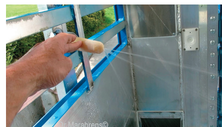
Abb. 8: Flüssigkeit spritzt im Überdruck aus dem Nippel; ein Saugen ist nicht möglich, © Dr. Marahrens
