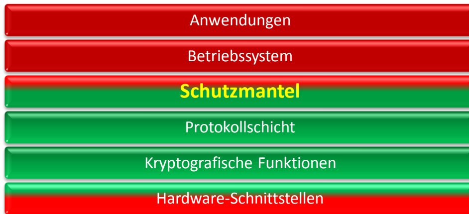
Bild 30: Einbindung des Schutzmantels in das Gerät
