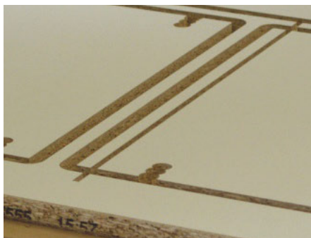
Zunächst führt die Maschine alle Bohr- und Fräsarbeiten aus, danach fräst sie auf Format
