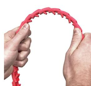
Obracaj zamocowanym pasem, tak by zakładki znalazły się wewnątrz (ustawione w dół, do rowka koła pasowego).
