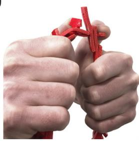
Con el pulgar, gire la segunda lengüeta 90°. Presione el extremo de la correa hacia abajo sobre la lengüeta con la otra mano. En el caso de los perfiles en forma de cuña, repita el procedimiento con la lengüeta restante.
