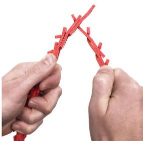
Halten Sie den Riemen mit den Laschen nach außen, und drücken Sie die Endlasche durch die beiden Verbindungsglieder (bei Keilprofilen drei Verbindungsglieder). Drehen Sie die Lasche um 90° in die beabsichtigte Position.
