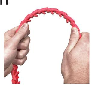
Gire la correa montada de manera que las lengüetas queden del lado interno (mirando hacia abajo en la ranura de la polea).
