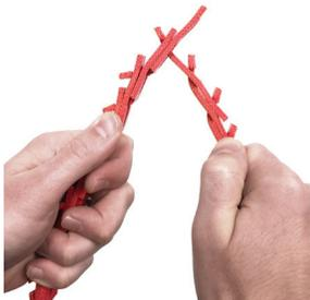
En tenant la courroie avec les ongles orientés vers l'extérieur, faites pénétrer l'onglet de l'extrémité à travers deux maillons (trois maillons pour les formes trapézoïdales). Faites pivoter l'onglet de 90° pour le mettre en place.
