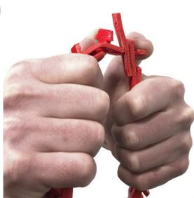
Drehen Sie mit Ihrem Daumen die zweite Lasche um 90°. Drücken Sie das Ende des Riemens mit der anderen Hand nach unten über die Lasche. Wiederholen Sie bei Keilprofilen den Vorgang für die verbleibende Lasche.
