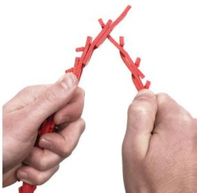
Tenendo la cinghia con le linguette verso l'esterno, far passare la linguetta terminale attraverso due maglie (tre per i profili a cuneo). Ruotare la linguetta in posizione di 90°.
