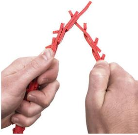
Поверните ремень накладками вверх и вставьте конечную накладку в отверстия в двух звеньях (для ремней с клиновидным профилем — трех). После этого поверните накладку на 90°.
