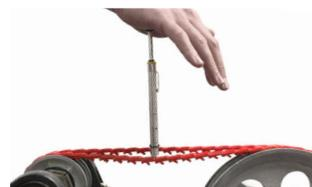
Sprawdź siłę naprężenia tensometrem i upewnij się, że poniższe wymagania zostały spełnione.
