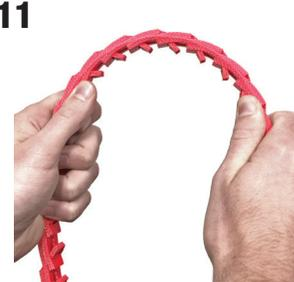
Drehen Sie den zusammengesetzten Riemen, sodass die Laschen innen liegen (nach unten in die Nut der Antriebsrolle zeigend).
