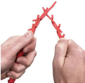
Trzymając pas zakładkami na zewnątrz, przeciśnij koniec pasa przez dwa segmenty (trzy dla profili klinowych). Przekręć zakładkę o 90°, by umieścić ją we właściwym miejscu.
