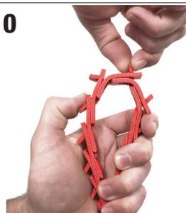
Stellen Sie sicher, dass alle Laschen komplett gedreht sind und quer zum Riemen stehen.
