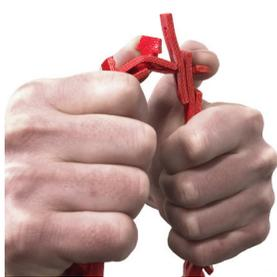
Kciukiem przekręć drugą zakładkę o 90°. Przeciśnij koniec pasa ponad zakładką w przeciwnej ręce. W przypadku profili klinowych powtórz czynność z kolejną zakładką.
