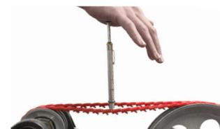
À l'aide d'un dynamomètre, vérifiez la force d'installation et confirmez qu'elle répond aux exigences ci-dessous.
