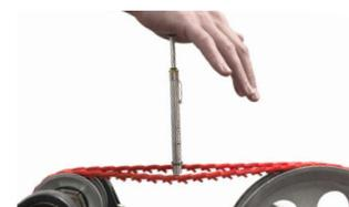
Usando um medidor de desvio de força, verifique a força da instalação e confirme se ela atende aos requisitos abaixo.
