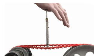
Misurare la forza di installazione usando un misuratore di deflessione della forza e verificare il rispetto dei requisiti sottostanti.
