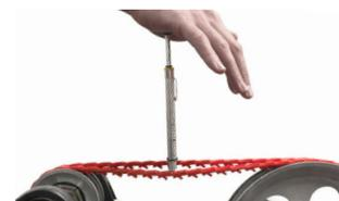
Prüfen Sie die Montagevorspannkraft mit einem Messgerät für das Biegemoment, und versichern Sie sich, dass die nachfolgenden Anforderungen eingehalten werden.
