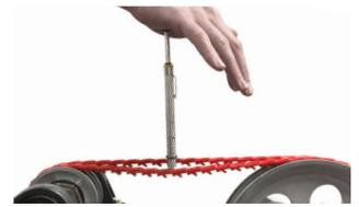
Используя прибор для измерения силы натяжения и угла отклонения, проверьте силу установки и убедитесь, что она соответствует указанным ниже требованиям.
