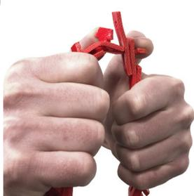
Utilizzare il pollice per ruotare la seconda linguetta di 90°. Con l'altra mano, spingere verso il basso la parte terminale della cinghia sulla linguetta. Per i profili a cuneo, ripetere l'operazione con la linguetta rimanente.
