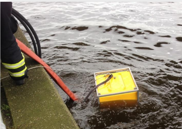
Schwimmpumpe im Wasser
