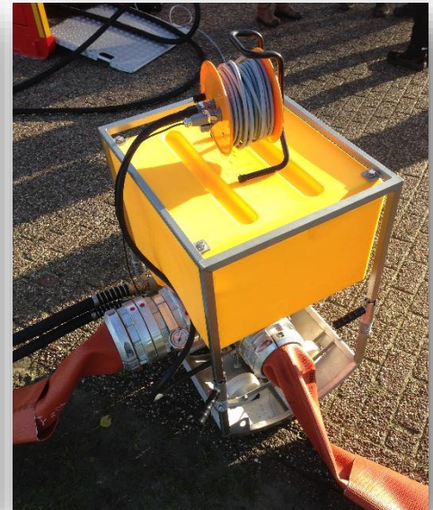
Schwimmpumpe in Reihenschaltung
