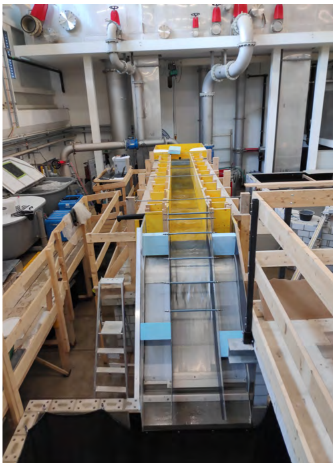
Bild 2: Versuchsstand, Rechenbreite auf 0,5 m verschmälert (Anblick vom Unterstrom).
