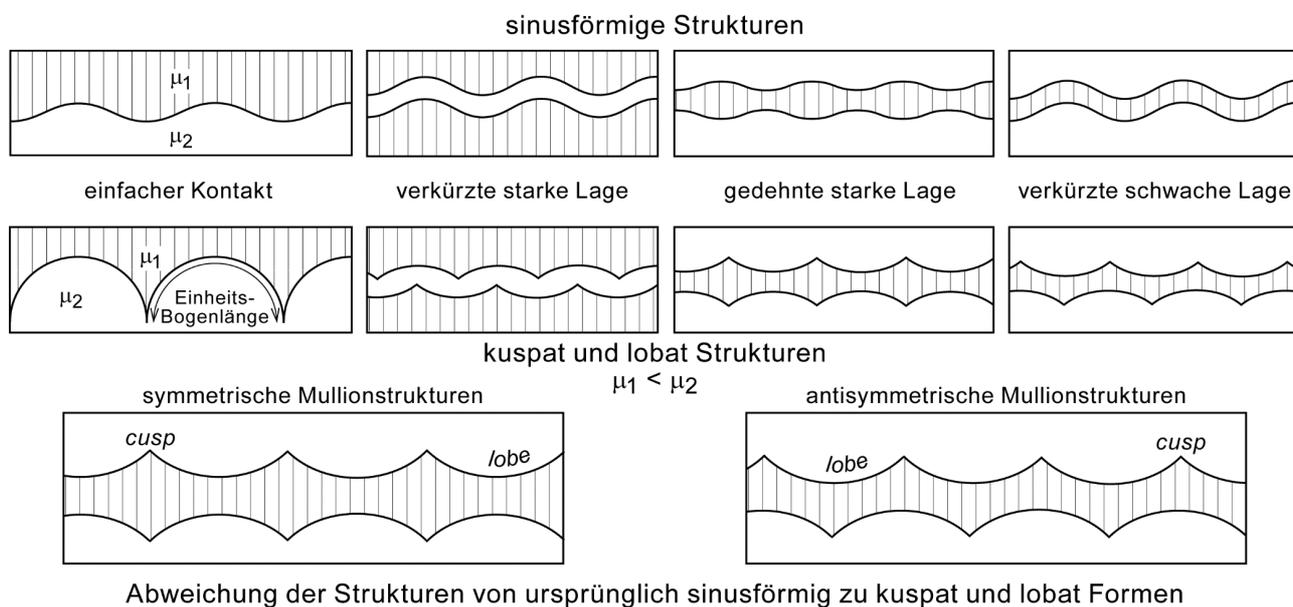
Diese *cusps* zeigen immer zum Material mit der höheren Viskosität. Folglich kann in Aufschlüssen mit Kuspatisch-Lobat-Falten auf den ersten Blick gesagt werden, welche Lage zur Entstehungszeit der Falten die steifere war. Dies ist eine weit verbreitete Ursache der Mullion-Strukturen.
