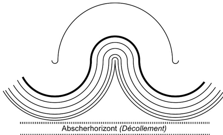
Die untere Grenze der inkompetenten Schicht bleibt im Wesentlichen entfaltet. Die inkompetente Schicht zwischen dem scheinbar ungestörten, flachen Liegende und dem unabhängig gefalteten Hangende ist ein "Décollement" Horizont. Der Jura wird oft zitiert für solche Beziehungen.
