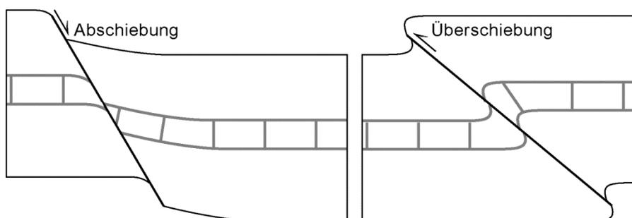
Durch die Betrachtung von Schleppfalten kann intuitiv darauf geschlossen werden, dass die Richtung der Falte in Richtung zur Verwerfungsbewegungsrichtung ist. Das kann zu falschen Resultaten
