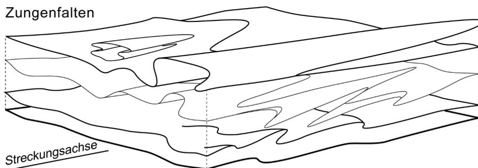
Leichte Biegungen der Ausgangswölbungsscharniere werden während der folgenden Scherung betont, bis Falten mit stark gekrümmten Faltenachsen gebildet werden. Im Umfeld progressiver Faltenamplifizierung können sich die Faltenachsen wie passive Marker verhalten und seitlich in die Scherrichtung hinein rotieren, bis sie bei sehr grossen Verformungen subparallel zur Scherrichtung zu liegen kommen. Zungenfalten sind also charakteristisch für die stark verformten Bereiche einer Scherzone.
