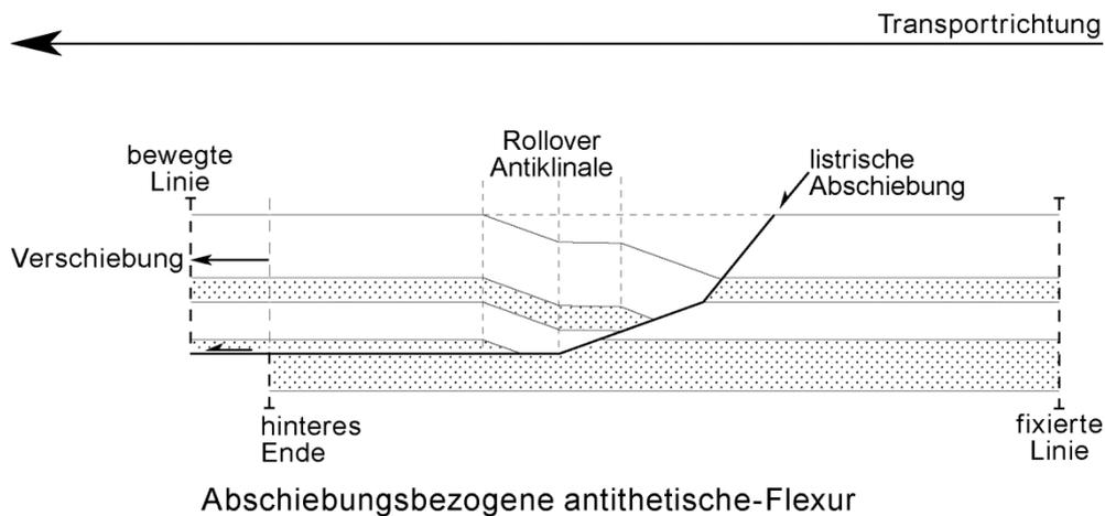
Während das Hangende entlang des tieferen, flach einfallenden Teils der Verwerfung gleitet, entsteht freier Raum zwischen den steileren Teilen der Verwerfung und dem bewegenden Hangenden. Die Schichtungen, die zuerst im Hangenden horizontal waren, müssen nach oben konvex gefaltet werden, um diesen Raum zu füllen.
