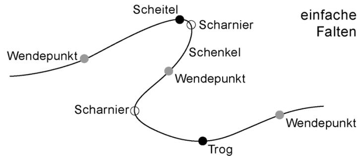
Falten sind dreidimensionale Strukturen. Die Verbindung der Scharnierpunkte auf einer bestimmten gefalteten Fläche definiert die **Scharnierlinie** oder **Faltenachse** (*fold axis, hinge line*). Die Faltenachse ist das wichtigste strukturelle Element einer Falte, da die Strukturen in dieser Richtung maximale Kontinuität zeigen.
