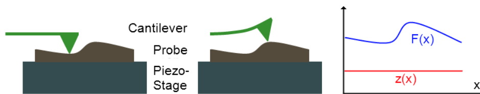
Abbildung 2.17: Schema zum Constant-Height-Mode eines AFMs
