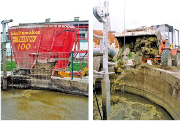
Abb. 3.15: Vor- bzw. Annahmegrube bei der Beschickung [FNR/M. Paterson (links); Hugo Vogelsang Maschinenbau GmbH (rechts)]
