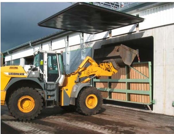
Abb. 3.27: Beispiele für Boxenfermenter, Fermenterbatterie [BEKON Energy Technologies GmbH & Co. KG]
