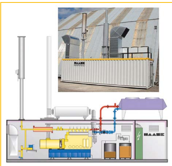
Abb. 6.5: Biogas-BHKW, Kompletzmodul in Kompaktbauweise mit Notfackel [BMF HAASE Energietechnik GmbH]
