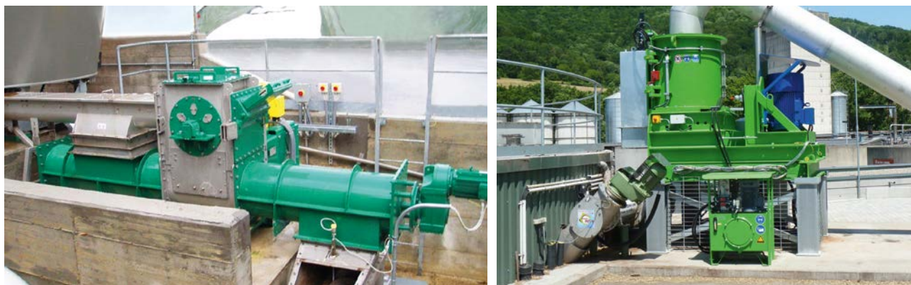
Abb. 3.7: Hammermühle (links) und Querstromzersetzer (rechts) zur Zerkleinerung fester Substrate [Huning Maschinenbau GmbH (links) und Universität Hohenheim (rechts)]
