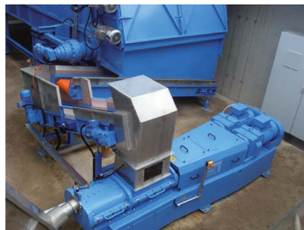
Abb. 3.11: Hydrothermale Desintegration mit Bioextruder [Lehmann Maschinenbau GmbH]
