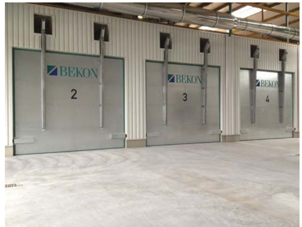
Abb. 3.27: Beispiele für Boxenfermenter, Fermenterbatterie [BEKON Energy Technologies GmbH & Co. KG]
