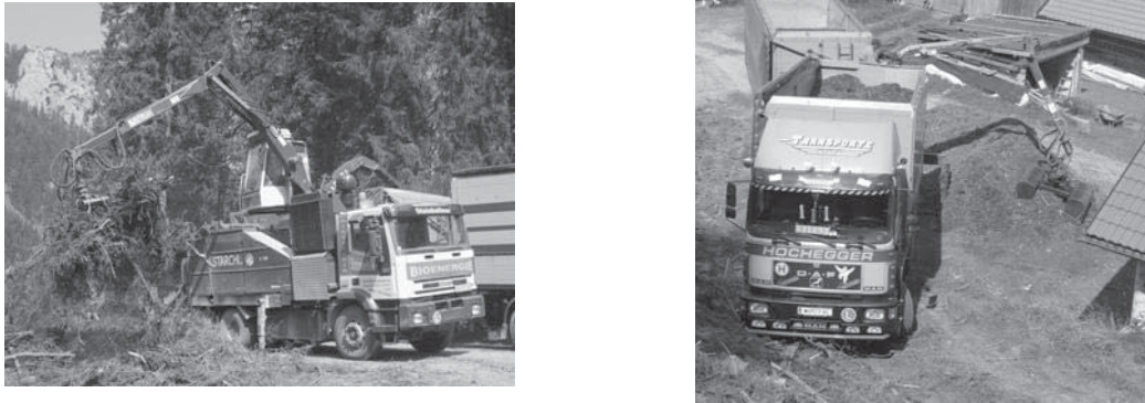
Abbildung 2: Transport-Lkw mit Ladekran beim Laden einer Fuhre (rechts) und mobiler Großhacker auf Lkw beim Hacken von Schlagrücklass (links).
