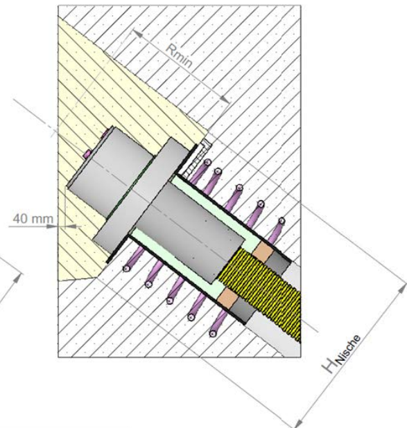
Geschlossene Nischenkonstruktion (Ankerkopf einbetoniert)
