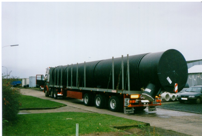
Bild 1: Aus Wickelrohr hergestellter Stauraumkanal
