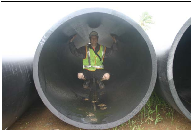
Bild 7: PE-Rohr d 1400 SDR 26
