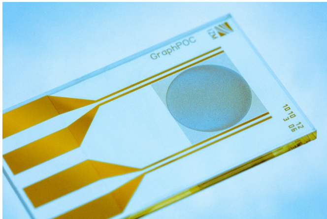
Abb. 1 Fraunhofer-Forschende entwickeln Biosensoren, die auf Graphenoxid basieren und es ermöglichen, bakterielle und virale Infektionen in nur 15 Minuten zu erkennen.
