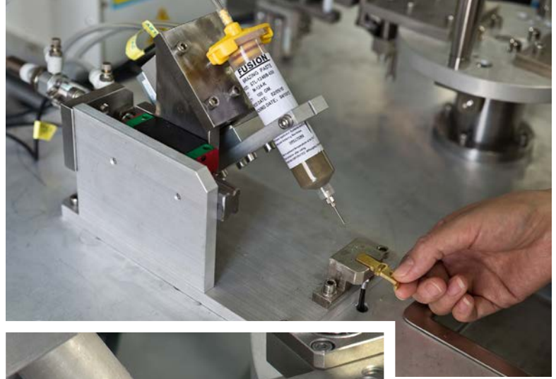
Vor der Induktionserwärmung wird Silberlötpaste aus einer Kartusche auf eine elektrische Kontaktkomponente aufgebracht.
