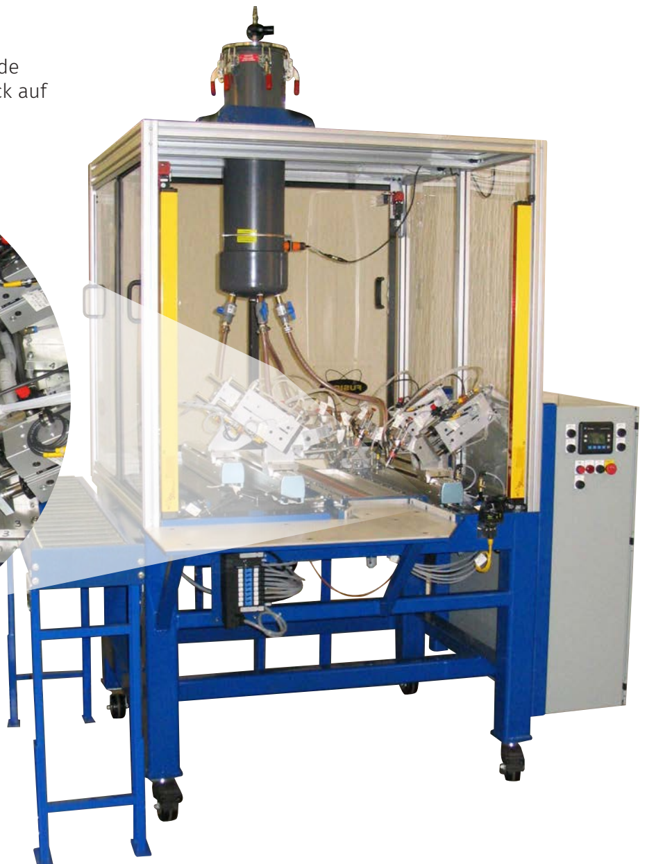
Einfachachsroboter führen die Applikationsdüse für die Kupferpaste mit einer Geschwindigkeit von 6200 Anwendungen pro Stunde zu den Lötstellen. Nach Applikation der Paste wird das Werkstück in einen Gasschutzofen eingeführt.
