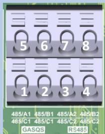
485/1 und 485/2 sind zwei separate eigensichere Stromkreise, die von der Erde isoliert gehalten werden müssen. Die Co/Lo- oder Kabellänge für jeden Stromkreis hängt von der angeschlossenen Barriere oder dem zugehörigen Gerät ab. Nachfolgend finden Sie die empfohlenen Optionen.
