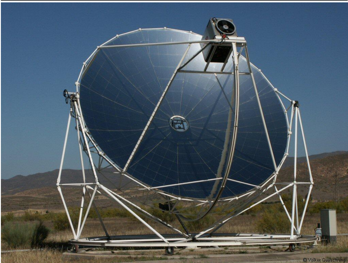
Abbildung 8: EuroDish-Prototyp an der Forschungseinrichtung PSA bei Almería in Südspanien [19]
