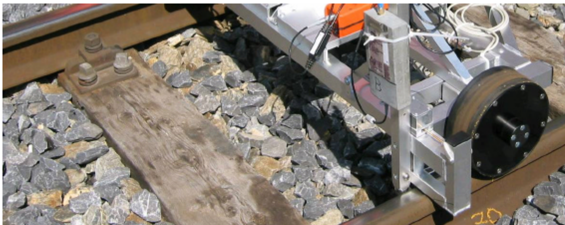
Abbildung 3: Rad des Gleismesswagen mit Odometer
