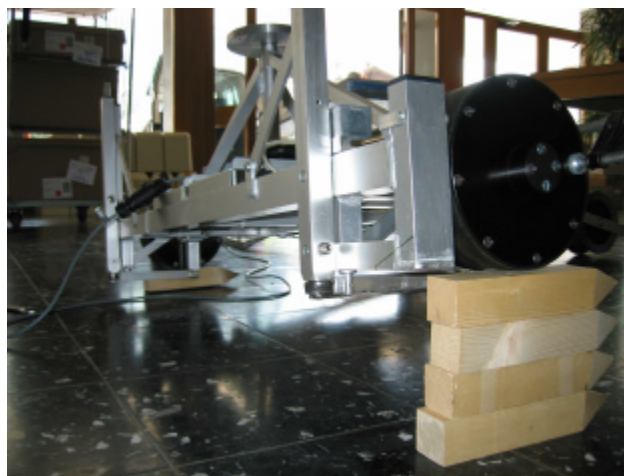
Abbildung 8: Messanordnung zur Neigungsmessung
