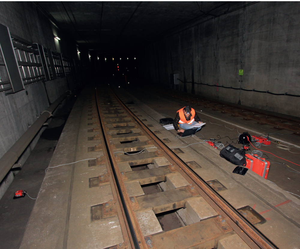
Abb. 3: Messgeräte im Messquerschnitt mit Masse-Feder-System (MFS)
