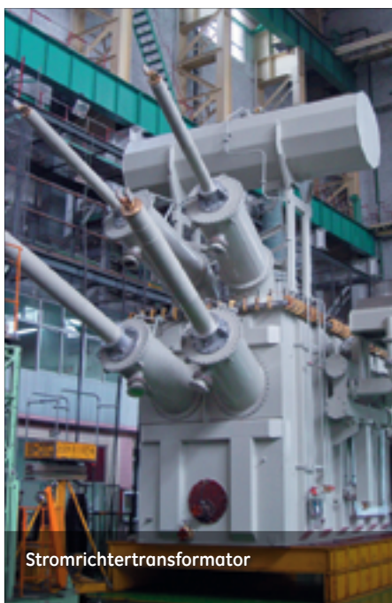
Stromrichtertransformator 301 MVA, 500 kV für Back-to-Back-Schaltanlage \pm 50 kV GÜ
