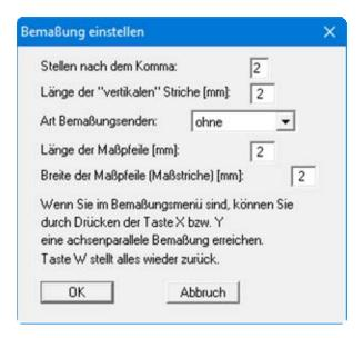
In der obersten Zeile können Sie die Stellen nach dem Komma einstellen, die bei einer späteren Bemaßung auf dem Bildschirm ausgegeben werden. Wenn als Art der Bemaßungsenden "**Maßstriche**" wählen, werden senkrecht zur Bemaßungslinie Maßstriche eingetragen, deren Länge Sie definieren können.
