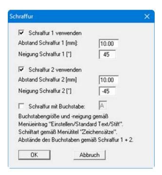
Sie können zwischen 2 verschiedenen Schraffuren wählen, für die Sie den Linienabstand und die Neigung voreinstellen können. Auch die gleichzeitige Verwendung beider Schraffuren ist möglich, wenn Sie beide Schalter aktivieren.
