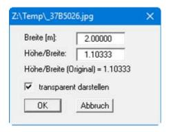
Sie geben die Breite und das Verhältnis von Höhe zu Breite ein. Die Grafik wird nun rasterförmig über den festgelegten Bereich gezeichnet. Ist der Schalter "**transparent darstellen**" aktiviert, erfolgt die Darstellung *durchsichtig*, d.h. dahinter liegende Linien oder Farbfüllungen bleiben sichtbar.
