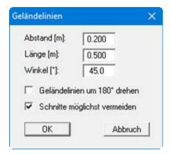
Sie definieren die gewünschten Abstände, Längen und Winkel der Geländeschraffur. Genau wie bei der Definition der Böschungslinien sollten Sie immer den Schalter "Schnitte möglichst vermeiden" aktivieren, damit in Ecken und Rundungen die Linien nicht übereinander gezeichnet werden. Auch bei den Geländelinien können Sie die Linien nochmals um 180° drehen, falls sie auf der falschen Seite eingezeichnet werden (siehe Abschnitt 6.3.7).
