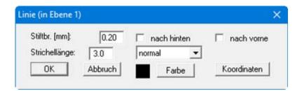
Sie können die Stiftbreite und die Stiftfarbe verändern sowie der Linie eine Strichelform zuweisen. Mit den Schaltern "nach hinten" oder "nach vorne" erreichen Sie, dass die Linie in der Zeichenreihenfolge als letzte oder als erste gezeichnet wird. Das ist vor allen Dingen sinnvoll, wenn Farbflächen in der Zeichnung vorhanden sind und Sie erreichen möchten, dass die Farbflächen die Linie nicht überdecken.
