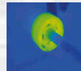
Countertrack™ Hitzentwicklung am Kugelkäfig-Kontakt (ca. 52 °C)
