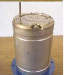
Entferne den Gehäusemantel, den Deckel der ersten Stufe und löse die Laufradhaltemutter.
