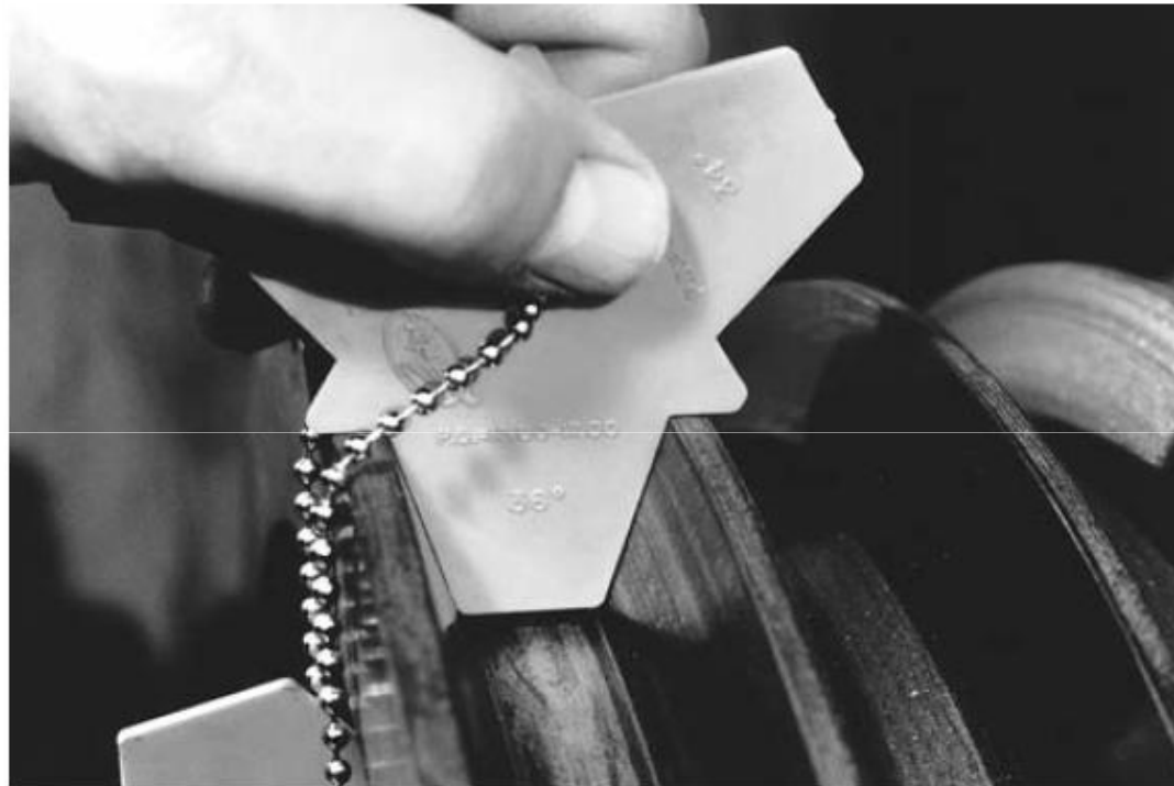
Gates Scheibenrillenlehren vereinfachen die Verschleißerkennung.
