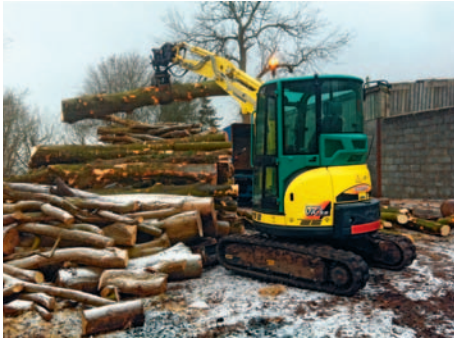
Bagger können auch «über Bodenniveau» arbeiten: Dieser Yanmar ViO33 sortiert und verlädt mit hydraulischem Greifer Baumstämme.
