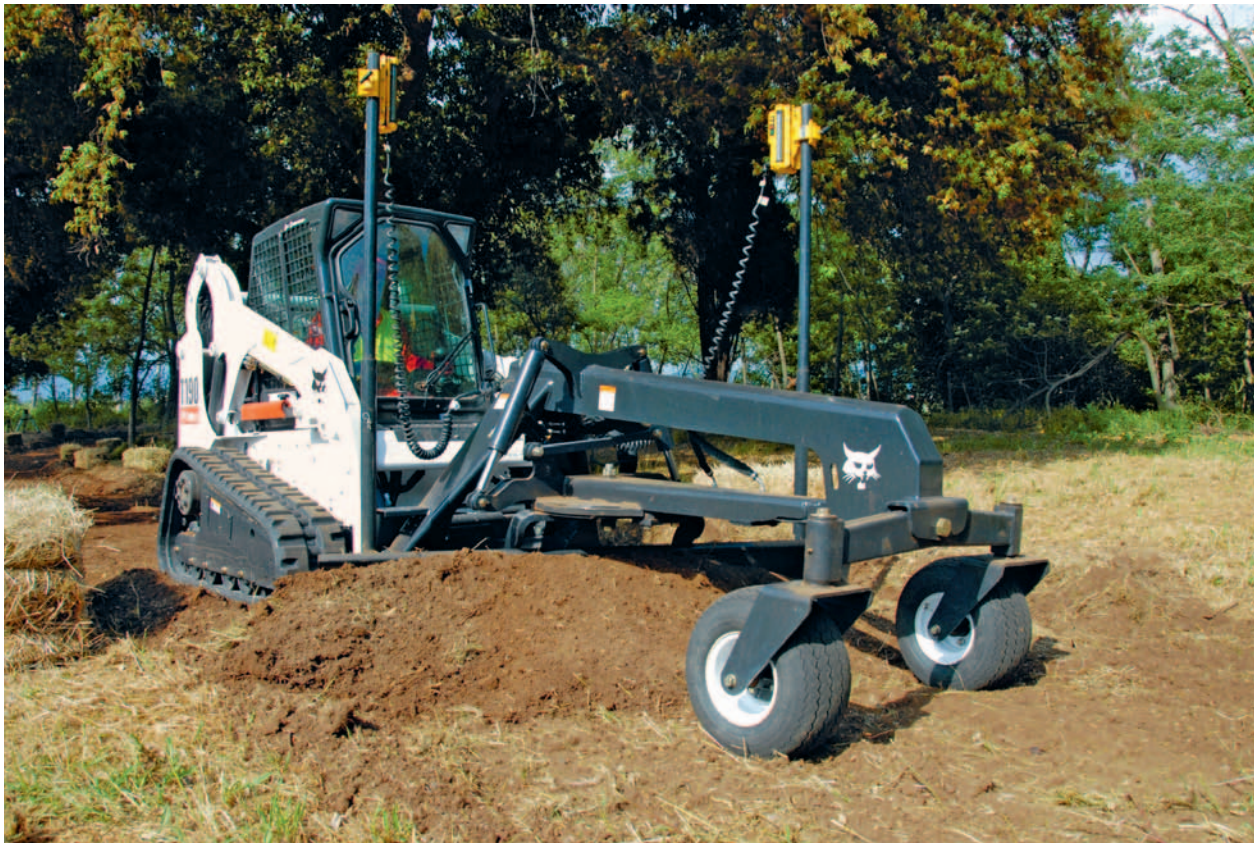
Zum präzisen Nivellieren können Kompaktlader am Schnellwechsler Vorbaugrader tragen. Diese gibt es auch lasergeführt, wie hier bei Bobcat.
