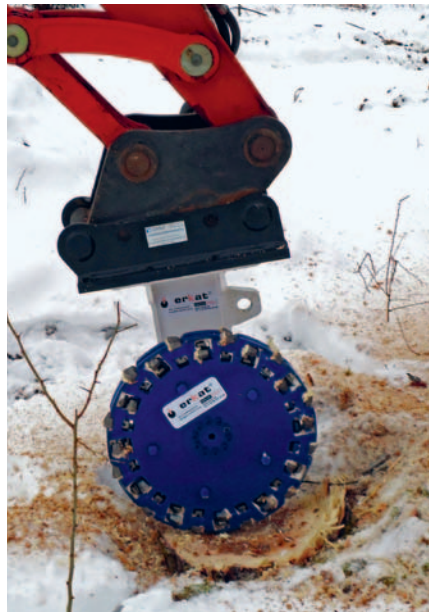
Mit der Universalfräse US30 von Erkat können selbst Bagger mit nur fünf bis zehn Tonnen Gewicht Beton abtragen, Gräben ziehen, aber auch Baumstümpfe zerkleinern.
