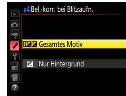
Mit der Option *Nur Hintergrund* wird dagegen nur die Belichtung korrigiert, so dass der Hintergrund natürlich belichtet wird.
