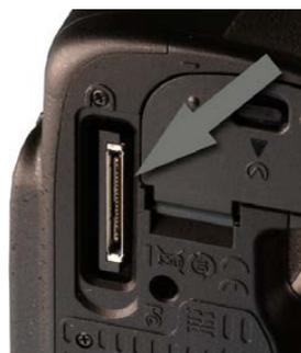
**MB-D15.** Ziehen Sie die Gummabdeckung ab, um den Anschluss für den Multifunktionsgriff freizulegen.
