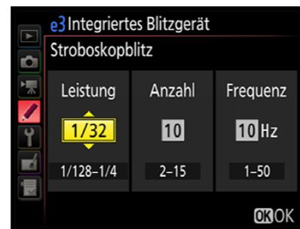
**3** Die *Anzahl* bestimmt in Abhängigkeit von der Frequenz, wie viele Blitze in der Sekunde bei geöffnetem Verschluss abgegeben werden. Den *Stroboskopblitz*
