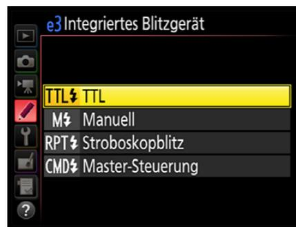
Standardmäßig ist die *TTL*-Option vorgegeben, bei der die Blitzleistung automatisch der Situation angepasst wird. Meist erhalten Sie damit bereits ganz ordentliche Ergebnisse.
