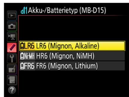
Im Menü *d11 Akku-/Batterietyp (MB-D15)* stellen Sie den verwendeten Batterietyp ein, um eine einwandfreie Funktionalität zu gewährleisten.
