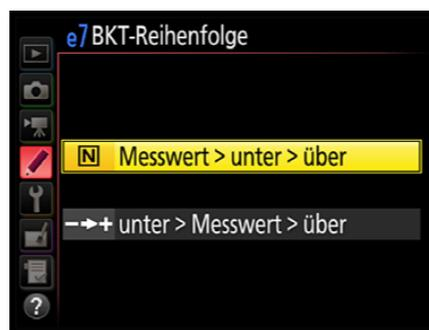
Mit diesen beiden Optionen bestimmen Sie, in welcher Reihenfolge die Bilder bei Belichtungsreihen gespeichert werden. Standardmäßig ist dies zuerst der Normalwert. Dann folgt die unterbelichtete Variante und abschließend die überbelichtete Version. Falls Ihnen diese Standardvorgabe nicht zusagt, aktivieren Sie die zweite Variante, bei der von dunkel nach hell sortiert wird.
