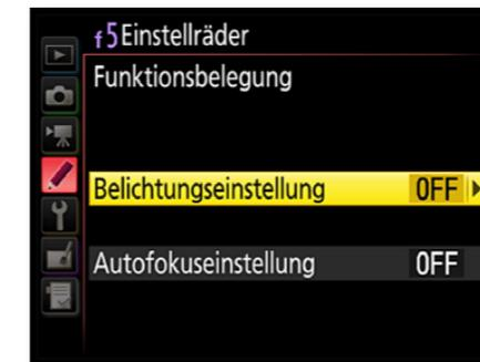
Wollen Sie also die Blende lieber mit dem hinteren Einstellrad verstellen, wählen Sie die Option *Vertauscht*. Haben Sie die Funktion *Vertauscht (A)* eingestellt, wird die Blende nur im Belichtungsmodus A mit dem hinteren Einstellrad geändert.
