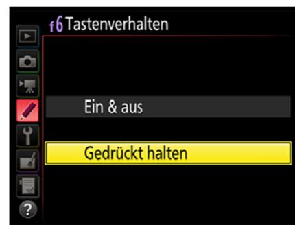
Die Funktion ist für all diejenigen interessant, denen es zu kompliziert erscheint, bestimmte Tasten gedrückt zu halten. Bei einigen Tasten ist es erforderlich, sie gedrückt zu halten, während mit dem Einstellrad die Werte verändert werden – wie etwa die QUAL- oder die ISO-Taste und einige mehr.
