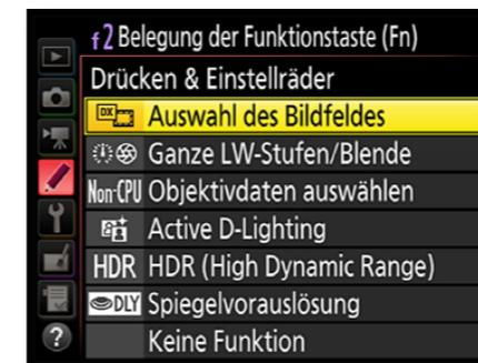
1 Mit der Option *Auswahl des Bildfeldes* wird mit dem Einstellrad zwischen den verschiedenen zur Verfügung stehenden Formaten gewechselt.
