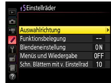
Nach dem Drücken der rechten Pfeiltaste des Multifunktionswählers wechseln Sie zum jeweiligen Untermenü. Die erste Funktion benötigen Sie, um die Drehrichtung der Einstellräder festzulegen.
