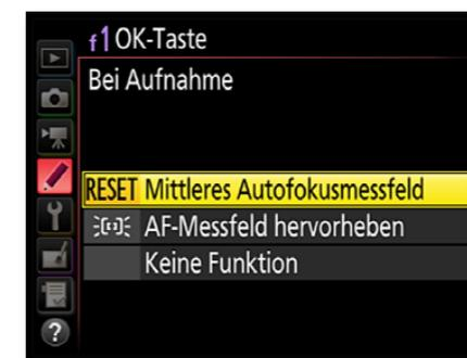
3 Standardmäßig wird die OK-Taste verwendet, um das mittlere Autofokusmessfeld auszuwählen, wenn die Messfeldsteuerung eingestellt und der Sperrschalter für die Messfeldvorwahl nicht verschlossen wurde.
