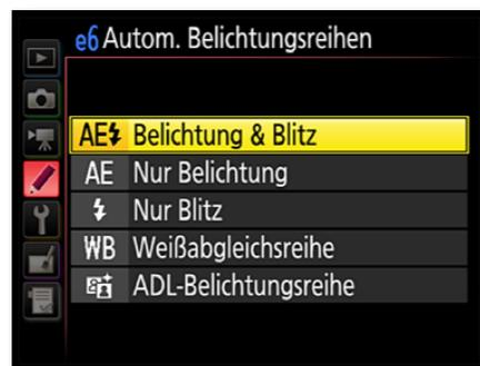
Standardmäßig werden bei der Belichtungsreihe Belichtung sowie Blitz variiert. Zudem können Sie auch beides voneinander trennen und nur eine Belichtungs- oder eine Blitzbelichtungsreihe durchführen. Daneben wird hier auch eingestellt, ob stattdessen eine Weißabgleich- oder eine ADL-Belichtungsreihe aufgenommen werden soll, was für das aktive D-Lighting steht.
