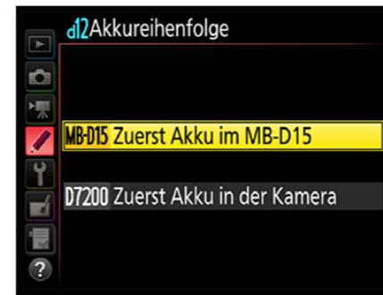
**2** Wenn Sie es vermeiden wollen, den Akku in der Kamera ständig zu wechseln, belassen Sie es bei der Standardvorgabe *Zuerst Akku im MB-D15*. Dann wird zunächst der Akku im Multifunktionsgriff geleert. Erst wenn dieser leer ist, kommt der Akku in der Kamera zum Einsatz.
