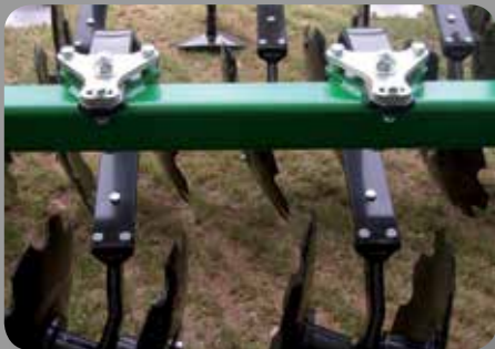
BEGRENZTE SCHEIBENWINKELVERSTELLUNG – Zur Bearbeitung von Äckern mit konsistenter Bodenbeschaffenheit ist kein voll verstellbarer Scheibenwinkel nötig. Die DTX bietet hierzu eine begrenzte Scheibenwinkelverstellung mit drei festen Stufen.
