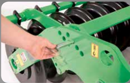
EINFACHE SCHEIBENTIEFENVERSTELLUNG – Die Tiefe der Heckwalze lässt sich schnell und einfach den verschiedenen Bodenbedingungen und Arbeitsgängen anpassen.
