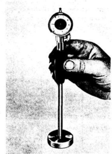
52 M Pleuellager mit Pleuellagerwerkzeug ausmessen (Skala auf „0“-Stellung drehen)
