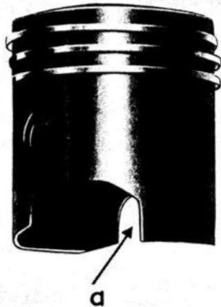
54 M. Kolben-Tragbilder a = eingefallener Kolben
