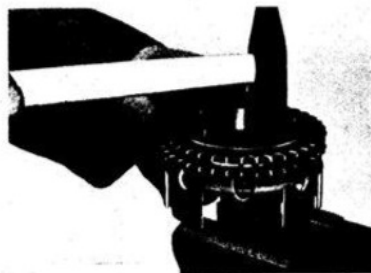
64 M Mitnehmer, Kupplungskettenrad und Kupplungstrommel zusammensetzen
