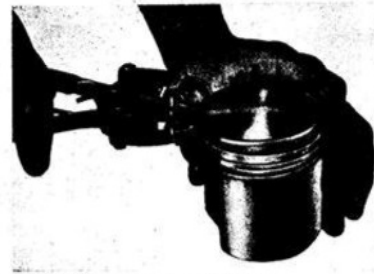
59 M Verdichtungsringe mit Zange abnehmen
