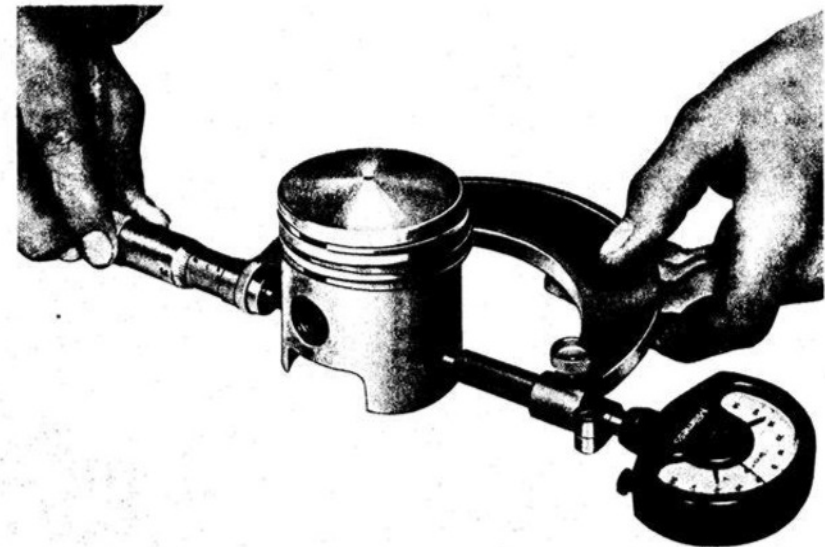
57 M Kolben mit Mikrometer messen
