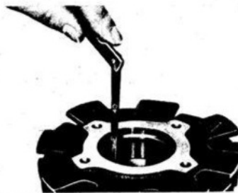
60 M Stoßspiel der Verdichtungsringe mit Fühllehre messen
