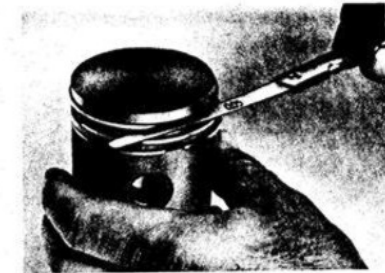
56 M Höhenspiel der Verdichtungsringe messen
