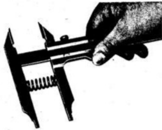
62 M Kupplungsfedern mit Schiebemaße messen
