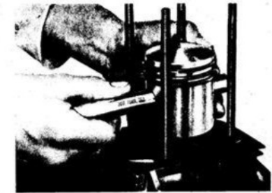
46 M Kolbenbolzen ausdrücken
