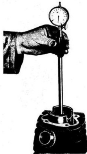
61 M Zylinder mit Innenfeinmeßgerät ausmessen
