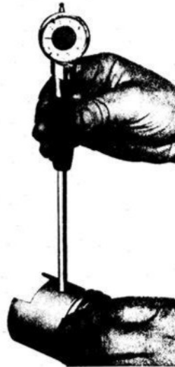
55 M Kolbenbolzenauge mit Innenfeinmeßgerät ausmessen
