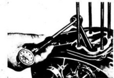
53 M Pleuellagerbüchse mit Pleuellagerwerkzeug ausmessen
