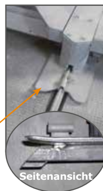
breite Auflage für Mittelbock, Rundeisen angeschweißt
