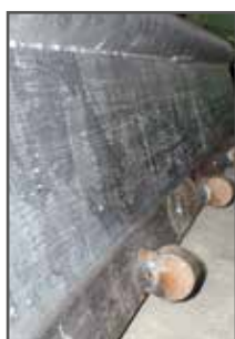
Rundeisenscheiben auf einer Schiene
