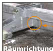
Räumklappenanschlag: kein Bodenkontakt
