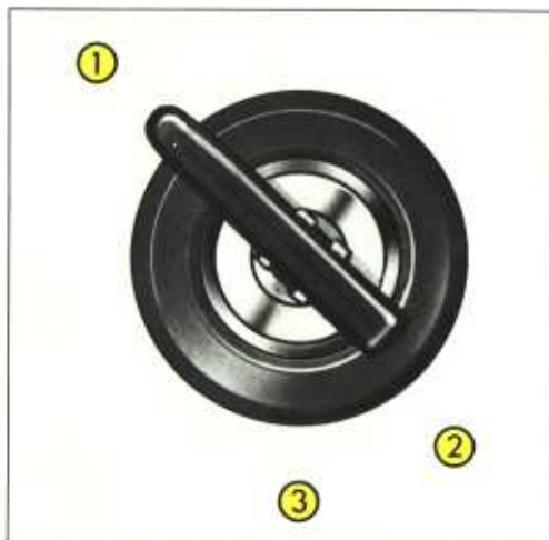
Abb. 13 – Zündschloß 1 – Diebstahlsicherung (Lenksperre) 2 – Zündung 3 – Starter
