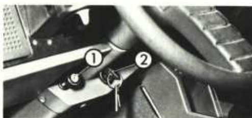
Abb. 14 – Starten des Motors 1 – Choke 2 – Zündschloß
