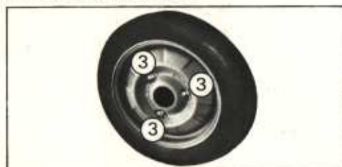
Abb. 3 – Radzierkappe abgebaut 3 – Befestigungsmuttern
