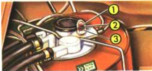
Abb. 1 – Hydraulikflüssigkeitskontrolle 1 – Max-Mark 2 – Schwimmer 3 – Min-Mark
