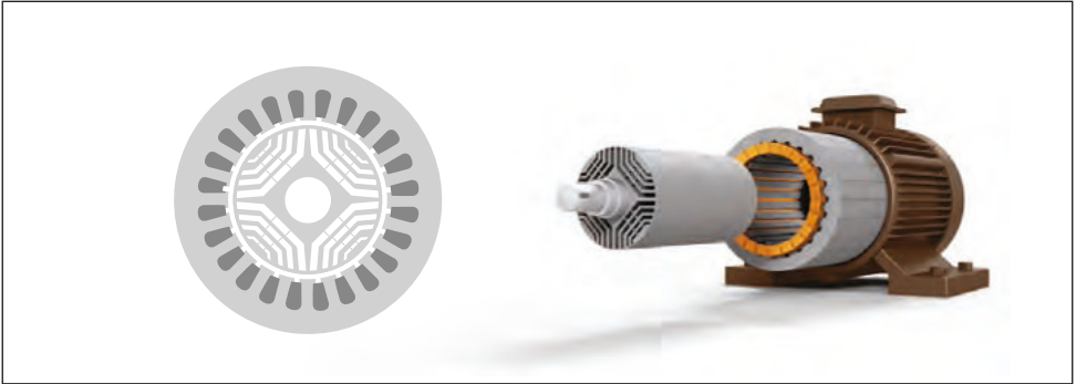
Abb. 1.31 Spezielle Gestaltung des Rotorblechs führt zu hohem Wirkungsgrad bei niedrigen Drehmoment-Rippeln
