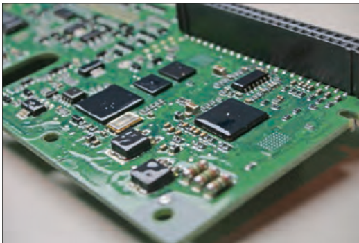
Abb. 9.8 Leiterplatte mit verstärkter Beschichtung
