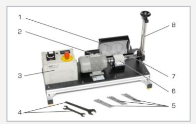
1 Schutzhaube, 2 Elektromotor, 3 Schaltkasten, 4 Werkzeug, 5 Proben, 6 Lager, 7 Probe eingespannt, 8 Belastungsvorrichtung mit Federwaage und Handrad
