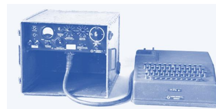
Kombinationsschreiber ETK 47/50 (ETT integriert), tot. Gewicht 27 kg, Einsatz 1950-1970, Beschaffung tot.: 150 Fernschreibcode: Start-/Stopverfahren 14-Schritt-Code
