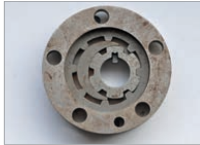
2 Innenzahnradpumpe mit Flugrost am Flansch
