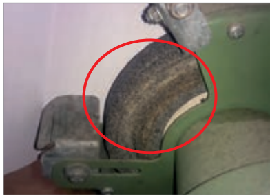
4 Unzureichende Spaltmaße an Schleifscheibe eines Schleifbocks
