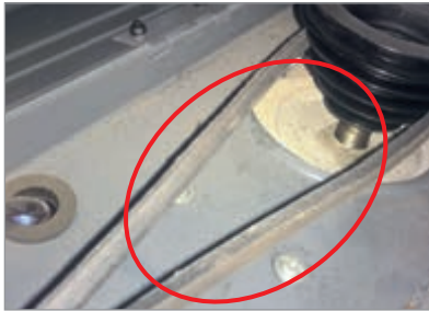
1 Ungenügend gespannter Riementrieb
