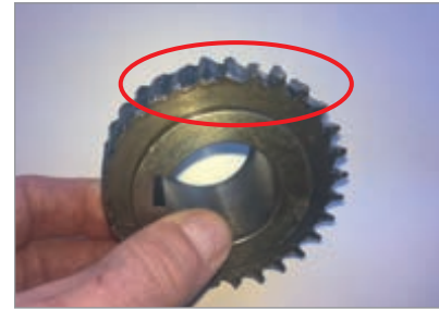
3 Zahnrad mit verschlissener Schrägverzahnung
