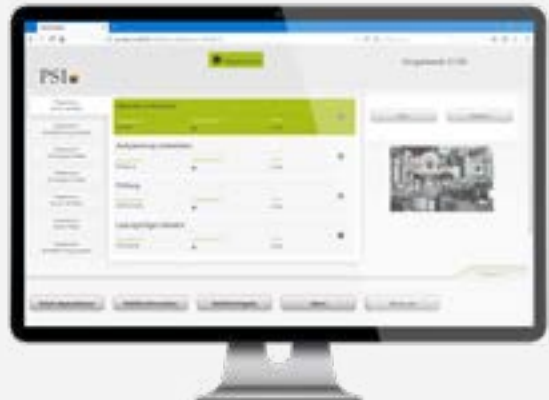
Abbildung: Das Werker-Cockpit unterstützt Mitarbeiter in der Produktion im Arbeitsablauf inklusive Grafiken und ablaufabhängigen Verfahrensanweisungen.
