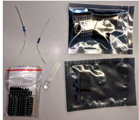
Abbildung 8: Bauteile vor dem Zusammenbau
