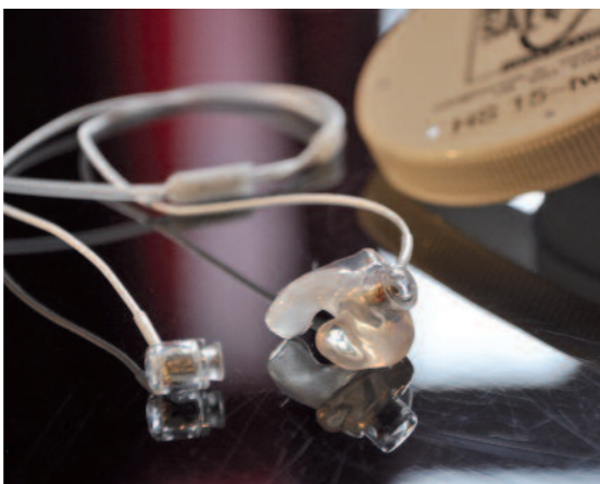
Der Hearsafe HS15 Twin verfügt über ein kombiniertes 2-Wege-System und ist deswegen nicht größer als die 1-Wege-Systeme
