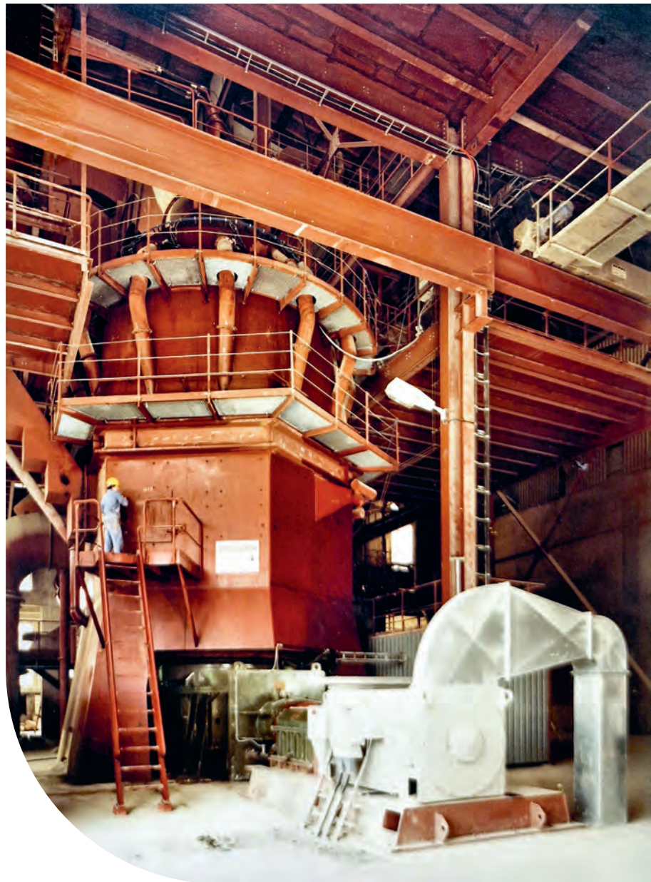
Zementmühle 11, die weltweit erste Walzenschüsselmühle für die Zementmahlung, 1978.
