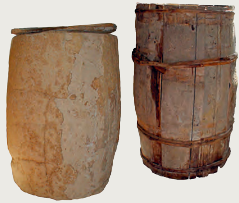
Romanzementfässer von einer im 19. Jahrhundert auf dem Inn gesunkenen Zementplatte (Lastkahn). Erhärteter Romanzement mit dazugehörigem, mit Weidenriemen gebundenen Fass, ausgestellt im Inn-Museum Rosenheim.
