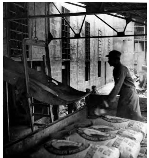
Die Sackverladung auf LKW durch eine Laderutsche war in Handarbeit zu verrichten, ca. 1950.
