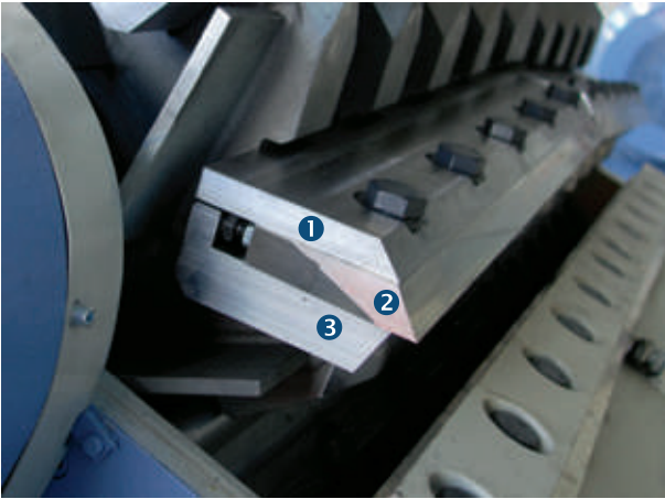
Abb. 3: ① Messerdruckleiste ② Rotormesser ③ Auswechselbares Verschleißteil.
