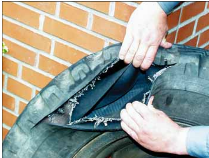
Innenseite aufgeplatzt: Der 22 Jahre alte Reifen eines TLF.
