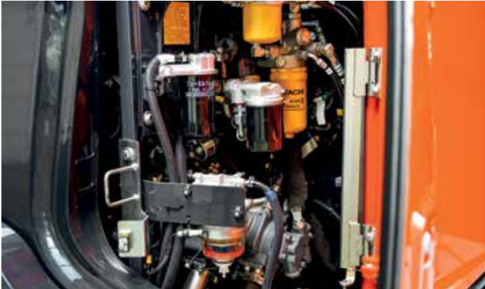
Bequemer Zugang zu allen Filtern in einem Fach.
