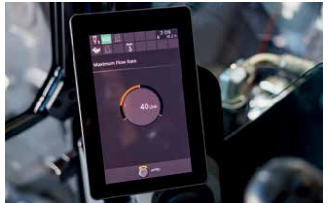
Der 8-Zoll-LCD-Farbmonitor ist dank der Anti-Spiegeltechnologie sehr gut ablesbar.
