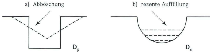
Abb. 2. Übergang des Erdfalldurchmessers D_p nach D_e (idealisiert).
