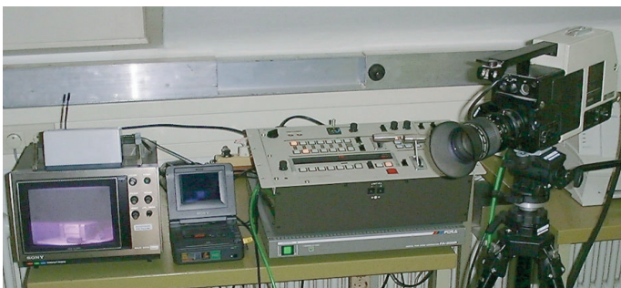
Abbildung 7: Die Videoausrüstung (von links nach rechts und von oben nach unten): Empfänger für die Helmkamera, Monitor zur Darstellung des überlagerten Bildes, Videorecorder, Videomischpult, Time Base Corrector zur Synchronisation, Kamera mit Stativ
