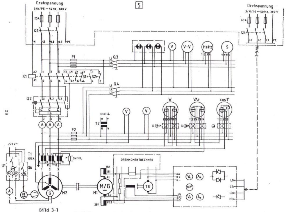
Schaltplan zum Praktikumsversuch: Synchronmaschine
