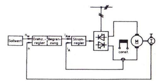
Bild 1.13-1 Drehzahlregelung nach dem Stromleitverfahren
