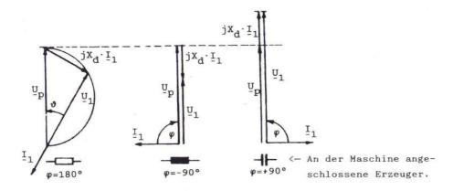
Bild 1.8-1 Zeigerdiagramme des Synchrongenerator für ohmsche, kapazitive und induktive Belastung (VZS).
