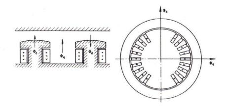
Bild 1.1-1 Synchronmaschine mit ausgeprägten Polen (Abwicklung)
