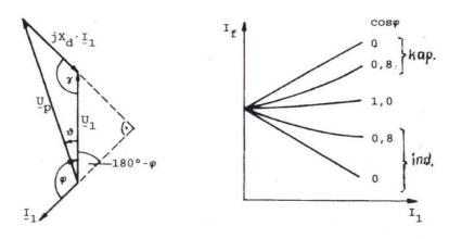
Bild 1.11-1 Vereinfachtes Zeigerdiagramm des Vollpolgenerators
