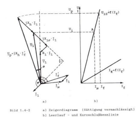
Der Winkel  $\, \varphi \,$  zwischen Strom und Spannung zählt positiv von  $I_1 \,$  nach  $\, U_1 \,$  in mathematisch positivem Umlaufsinn; der Polradwinkel  $\, \vartheta \,$  ist im selben Umlaufsinn von  $\, U_1 \,$  nach  $\, U_p \,$  positiv zu zählen. Es ist zu beachten, daß die Beträge der Zeiger  $\, U_1 \,$  und  $\, I_1 \,$  Effektivwerte der Strangspannung bzw. des Strangstromes darstellen.
