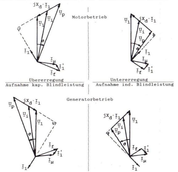
Bild 1.10-2 Vierquadrantenbetrieb der Synchronmaschine am Netz
