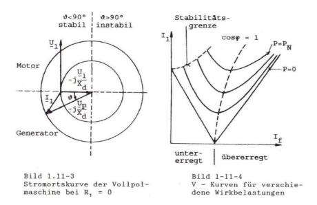
Die Minima des Stromes  $I_1$  liegen dort, wo die Blindkomponente  $I_{1b}=0$  ist; der Magnetisierungsbedarf der Maschine wird dann gerade durch die Gleichstromerregung des Polrades gedeckt. Rechts von der Verbindungslinie  $cos\phi=1$ ,0 herrscht Übererregung, links davon Untererregung.
