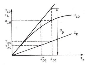
Bild 1.7-1 Leerlauf- und Kurzschlußkennlinie
