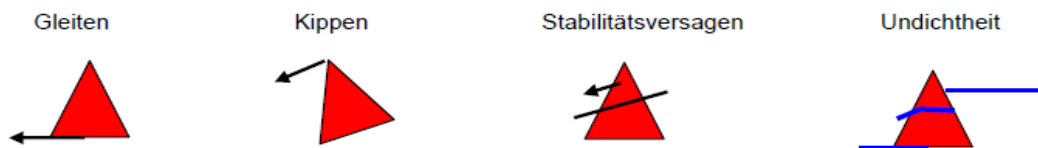
Abb. 44: Schadensbilder beim Systemeinsatz 56
