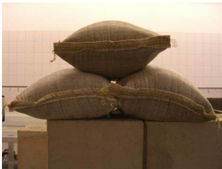
Abb. 3: Falsch gefüllte Sandsäcke
