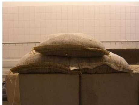
Abb. 4: Richtig gefüllte Sandsäcke
