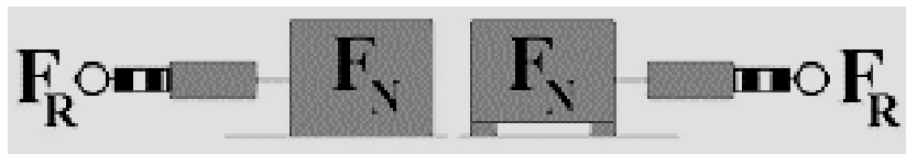
Abb. 25: Bestimmung von \mu_0 mit Kraftmessern 46
