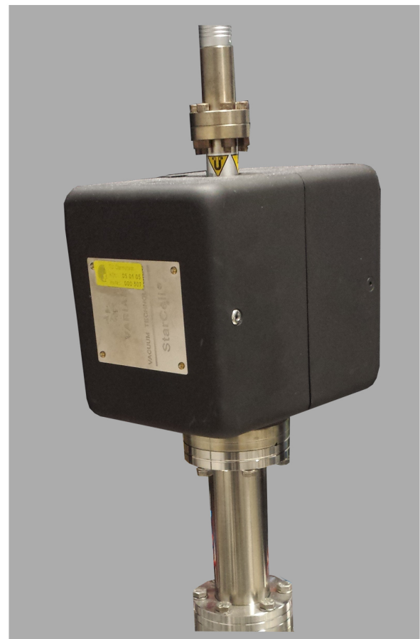
Abbildung 10: Schematische Skizze des Aufbaus einer Ionen-Getter-Pumpe (links) und Darstellung der im Versuch verwendeten Ionen-Getter-Pumpe (rechts)
