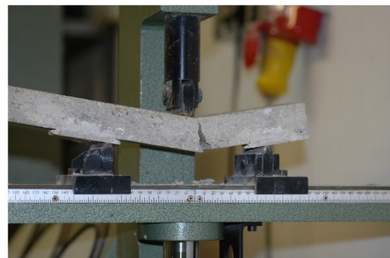
Abb. 6 Biegezugprüfung im IBF-Baulabor
