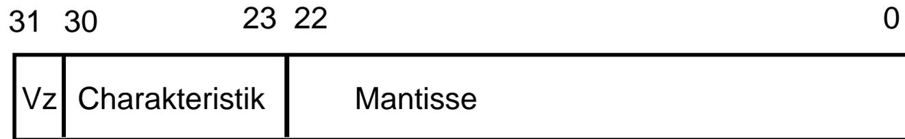
$$0 \text{ 100 0110 1 } \mathbf{1} \text{ 10 1111 0111 1100 0000 0000}_2 = 46\text{EF } 7\text{C00}_{16}$$
