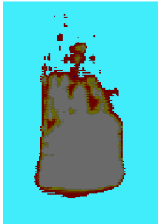
Bild 4.12 Temperaturverteilung während der Härtebearbeitung ( v = 3 \text{ m/min} , P = 2 \text{ kW} ).
