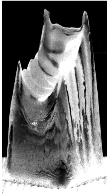
Bild 4.2 Gemittelttes Intensitätsprofil einer Scanneroptik, mit einem Plexiglaseinbrand sichtbar gemacht.
